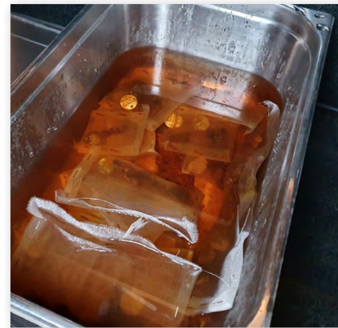
Die alkalische Badlösung zeigt bei der Eisenentsalzung schon nach wenigen Stunden erste Erfolge. Die Behandlung dauert aber oft mehrere Monate, wobei die Badlösung regelmäßig erneuert wird, bis keine Salze mehr austreten.
